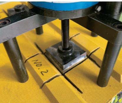
専用治具を接着固定して引っ張る
